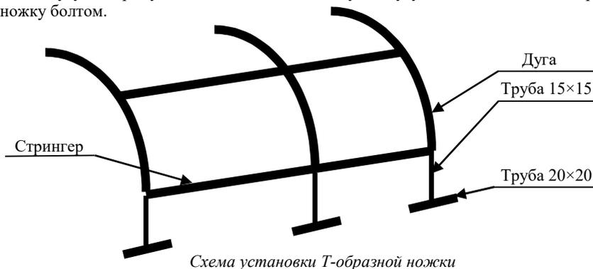
Аналогично установите остальные ножки (через дугу). Выройте ямки рядом с дугами, на которых установлены ножки, чтобы они в них поместились. Установите собранную теплицу таким образом, чтобы нижняя планка была на одном уровне с землей, а ножки ушли в грунт. Затем засыпьте землей и утрамбуйте. Для установки теплицы также можно использовать деревянный каркас или бетонный фундамент.
