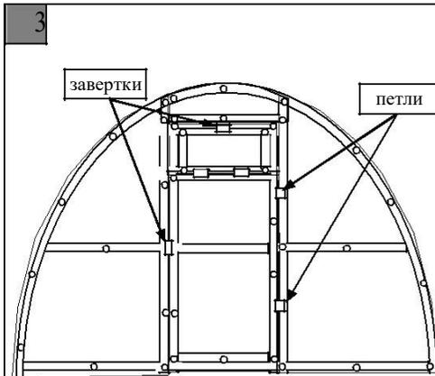
4.3.4 Установите петли на дверь и форточку с помощью саморезов. Все петли должны находиться снаружи поликарбоната. Прикрутите саморезами завертки на форточку и дверь. Затем, согласно отверстиям, прикрепите дверь.
